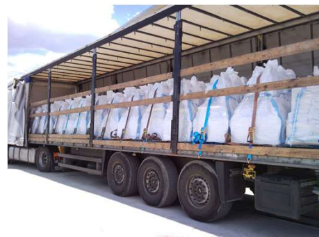
Примери за натоварване и укрепване на опасни товари по ADR
